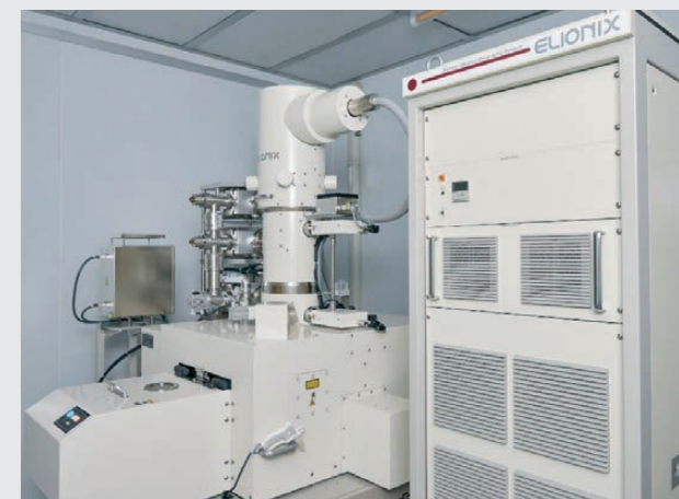
Elionix ELS F125 Ebeam Lithography System
